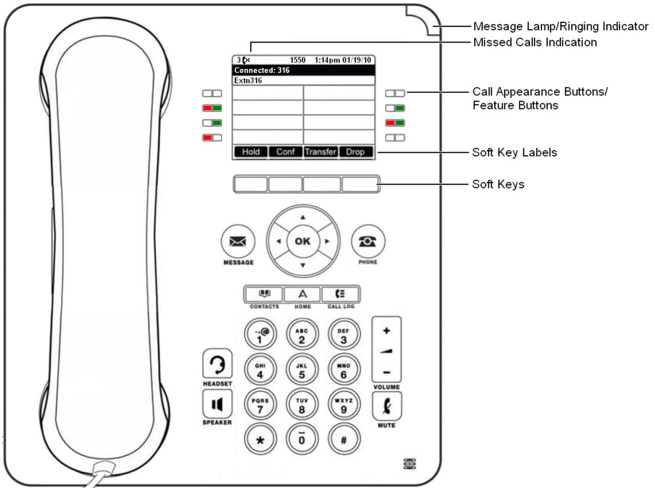
Das Telefon bietet 24 programmierbare Anrufpräsentations-/Funktionstasten. Die Beschriftungen dieser Tasten werden im Hauptfenster angezeigt und können über die neben stehenden Tasten bearbeitet werden.
